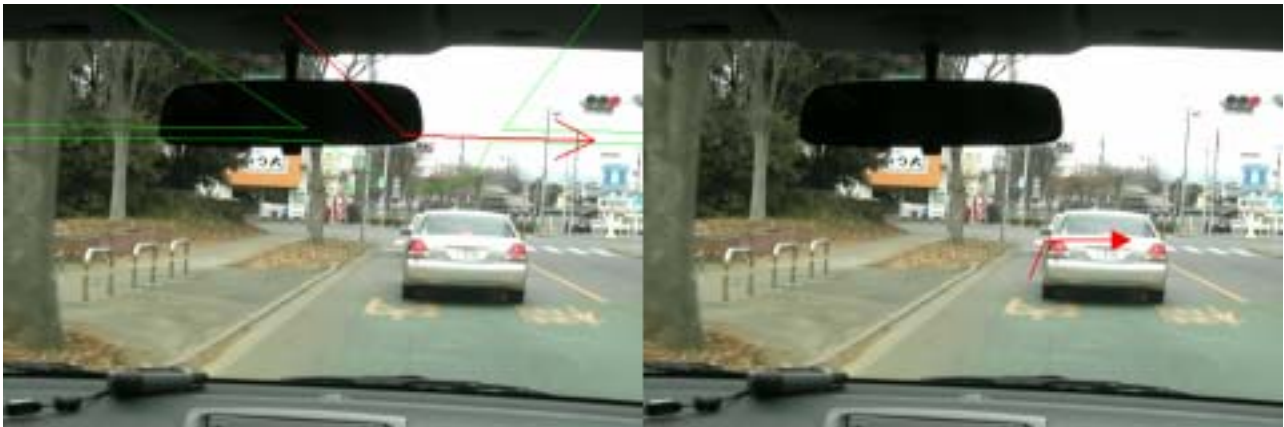
図 2：右折指示（左：道路鏡像による提案手法，右：路面重畳表示手法）
