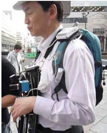
図1：歩行者視点カメラ装着の例
