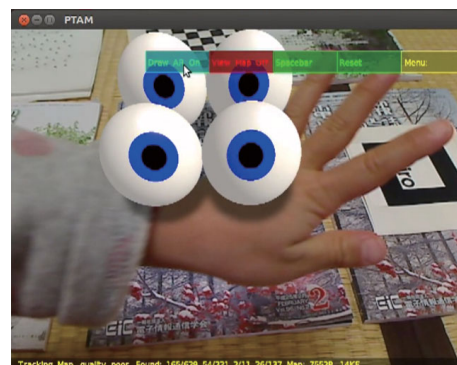
図7 PTAM プログラム カメラ視野中に広がって存在する自然特徴群を用いるので手がカメラ視野に入っても仮想物体は実世界に対して安定して表示され続ける。
