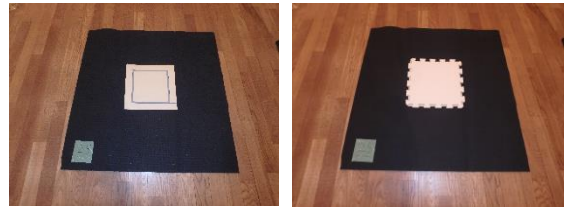
図 5 人工芝裏面の RFID タグ(左)とクッション(右)
