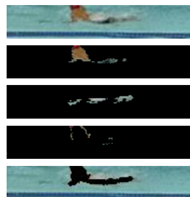
図 10 スレッドスコア評価値の高い注目領域(1 段目:注目領域, 2-5 段目:Tp,Fn,Fp,Tn 領域)
